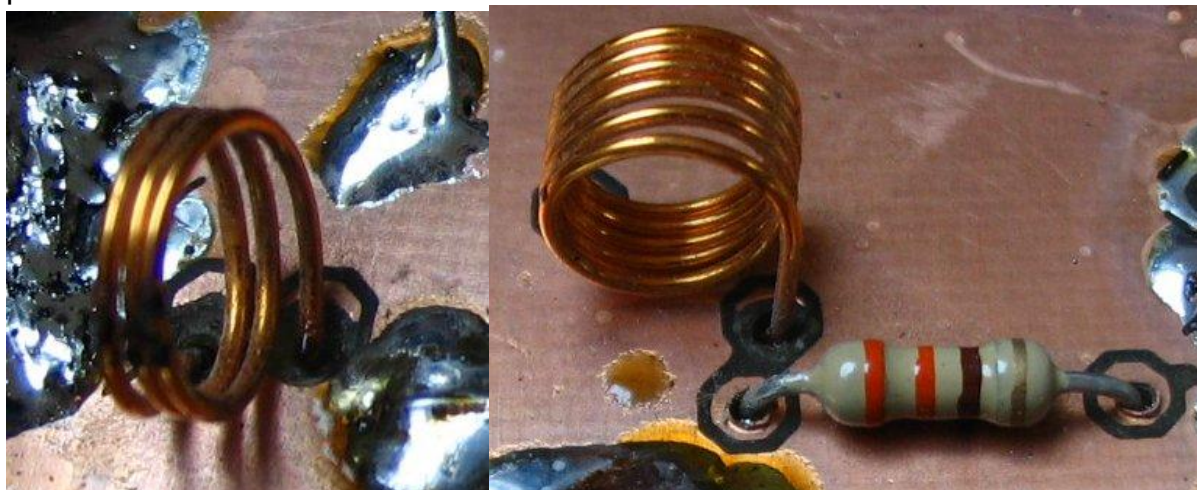
Figure 7a et 7b : Réalisation des inductances L3 et L4.
